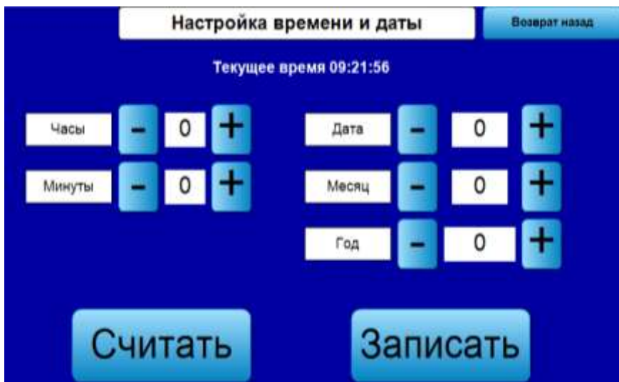
Рис 6.14. Экран настройки даты и времени на контроллере. Считать текущие значения, изменить необходимое и записать новые значения даты и времени.
