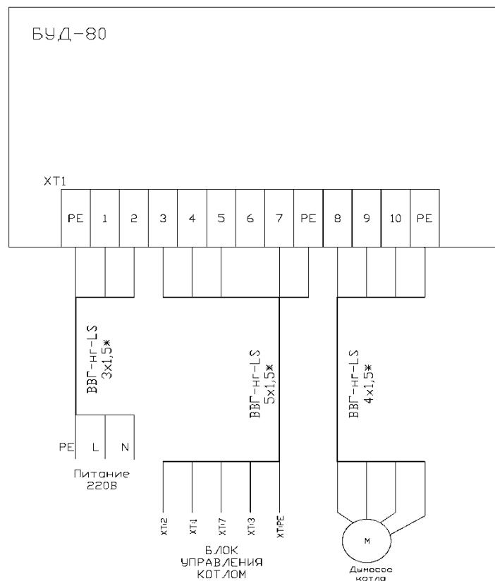
**СХЕМА ПОДКЛЮЧЕНИЯ БЛОКА УПРАВЛЕНИЯ КОТЛОМ ПРОМЕТЕЙАВТОМАТ140-300 кВт
