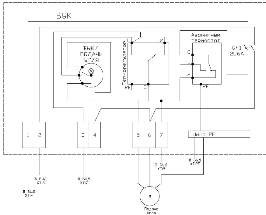
**СХЕМА ПОДКЛЮЧЕНИЯ БЛОКА УПРАВЛЕНИЯ ДЫМОСОСОМ ПРОМЕТЕЙАВТОМАТ 80 кВт
