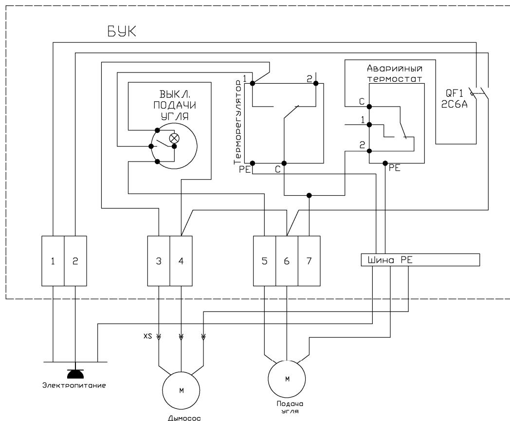
**СХЕМА ПОДКЛЮЧЕНИЯ БЛОКА УПРАВЛЕНИЯ КОТЛОМ ПРОМЕТЕЙ АВТОМАТ 80 кВт**
