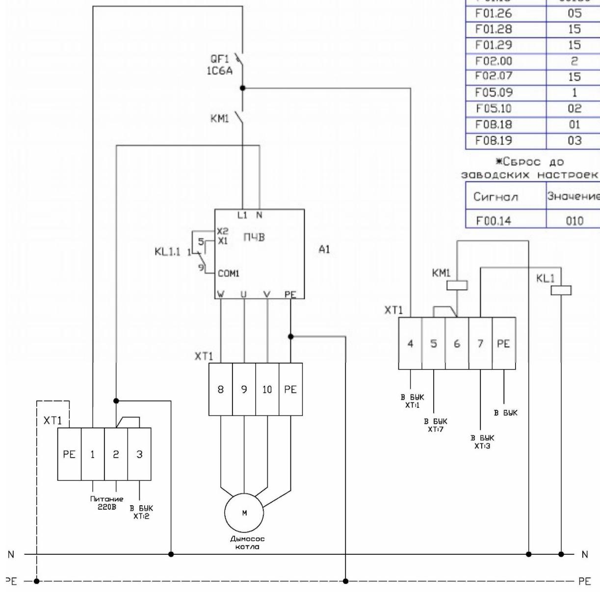
**СХЕМА ПОДКЛЮЧЕНИЯ БЛОКА УПРАВЛЕНИЯ ДЫМОСОСОМ ПРОМЕТЕЙАВТОМАТ 80 кВт
