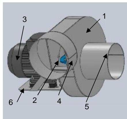
Рисунок 1 - Конструкция дымососа
