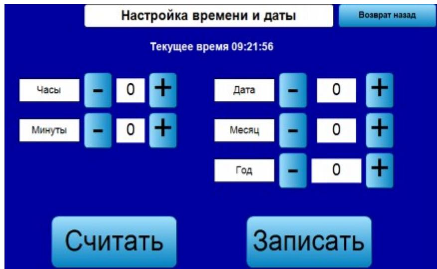
Рис 6.14. Экран настройки даты и времени на контроллере.
