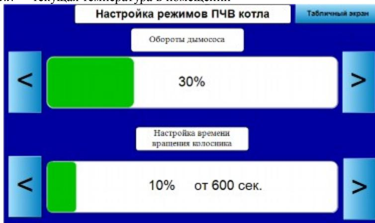
Рис 4. Экран оперативной настройки режима «Нагрев» котла.
