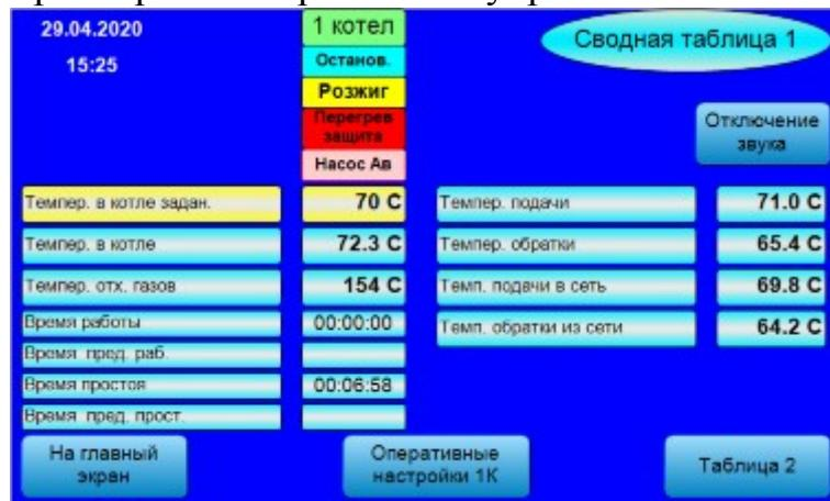
Рис 2. Сводная таблица текущих параметров работы котлов.
