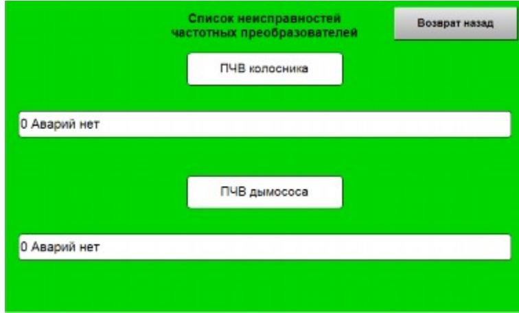
Рис 6.10. Экран состояния ПЧВ.
