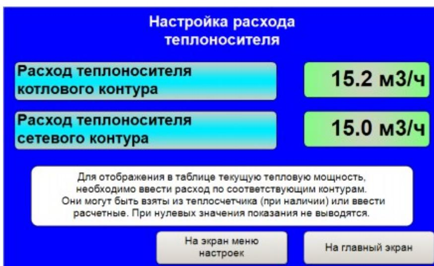
Рис 6.12. Настройка расхода теплоносителя.
